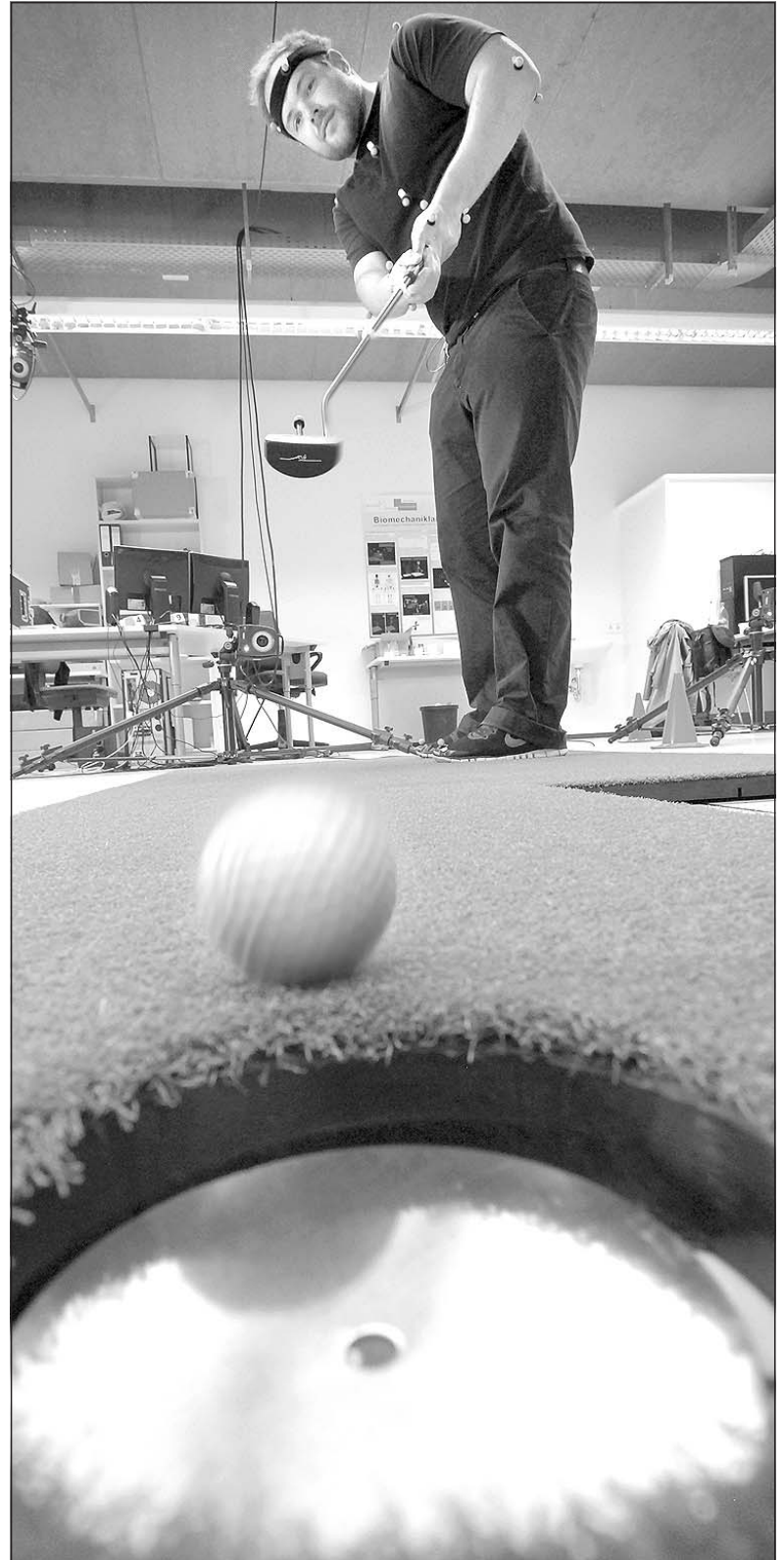
Philipp Philippen beim Putten im Labor. Zwölf Infrarotkameras zeichnen jede Bewegung genau auf und liefern Daten an den Computer.
